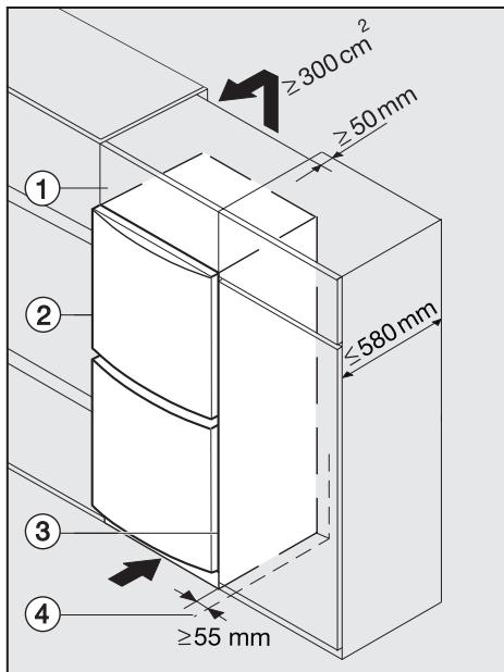
\* У приборов со смонтированными прокладками глубина прибора увеличивается прим. на 35 мм.
